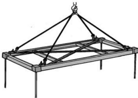
Подъем контейнера с использованием подъемной траверсы с крюками, такелажными серьгами или специальными замками
