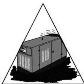
Слишком неравномерный или мягкий грунт. Установка стоит ненадежно.
